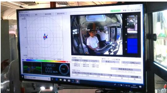
前後左右および上下方向の加速度（G）、速度（km/h）、ブレーキ・左右のウィンカー・前後ドアの状況等、運転に関するデータをリアルタイムで表示・視聴できます。
